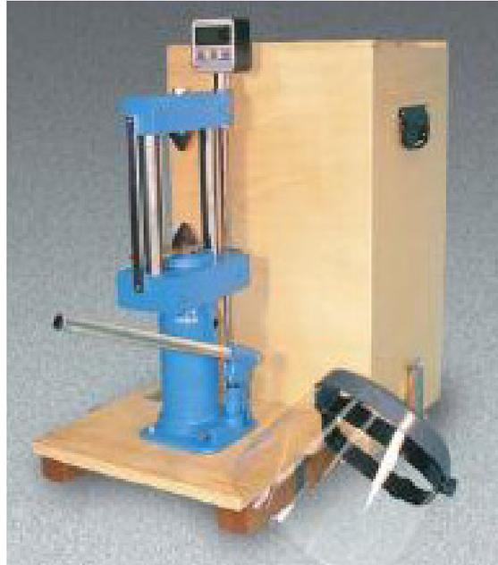
Figure 12.14.1.6-1. Point-load test apparatus.
